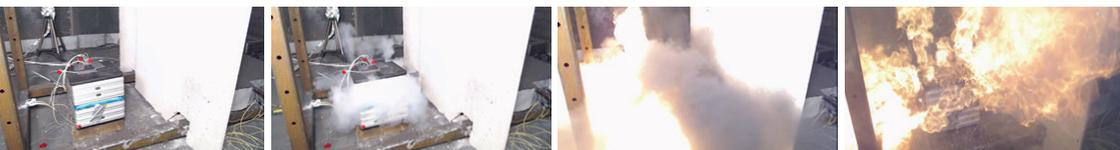
Havarie (innerer Kurzschluss) einer Lithium-Ionen-Batterie in Testumgebung
